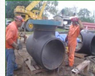
FABRICACION DE PIEZAS ESPECIALES TAPONES, REDUCCIONES, TEE, CON TUBERIAS DE DIFERENTES DIAMETROS. (TRABAJOS REALIZADOS PARA LAS CIA TELEVENT, GLOBAT OFFSHORE Y CONSTRUCTORA DIAZ IGA)
