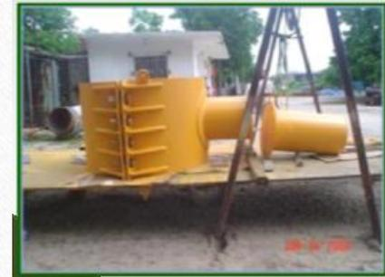
SUMINISTRO Y FABRICACIÓN DE PIEZAS ESPECIALES (ABRAZADERAS, SPOOL, REDUCCIONES, ETC), INCLUYENDO SUS PRUEBAS CON INSPECCIÓN RX, INSPECCIÓN ULTRASÓNICA, PRUEBA DE CONTINUIDAD, APLICACIÓN DE SANDBLAST, PRIMARIO Y ACABADO (SEGÚN ESPECIFICACIONES SOLICITADAS), CORROBORANDO ESPESORES, PRUEBA DE ADHERENCIA. ( TRABAJOS REALIZADOS PARA LA CIA GLOBAL OFFSHORE)
