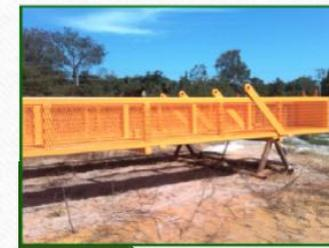
SUMINISTRO, HABILITADO Y FABRICACIÓN DE 02 RACKS PARA TUBERIAS DE EMBARQUE Y DESEMBARQUE DE PERFORACIÓN DE 10x 120x 090MTSASI COMO APLICACIÓN ANTICORROSIVA SISTEMA 3. (TRABAJOS REALIZADOS PARA LA CIA HALLIBURTON)
