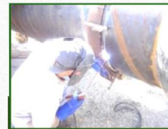
FABRICACION DE SPOOL CON TUBERIAS DE DIFERENTES DIAMETROS, MANEJO, CORTE Y SOLDADURA A PLACAS, TUBERÍAS Y JUNTAS DE DIVERSOS ESPESORES CON PERSONAL ESPECIALIZADO Y CERTIFICADO. ( TRABAJOS REALIZADOS PARA LA CIA GLOBAL OFFSHORE)
